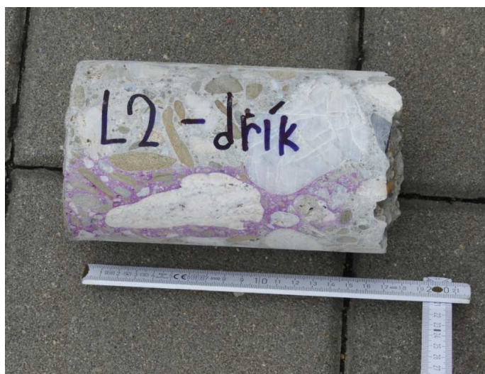
výnos z vrtu s fenolftaleinovým testem
