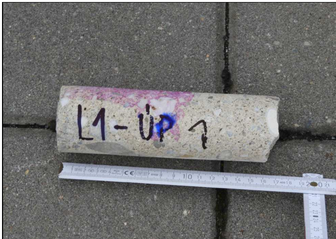
výnos z vrtu s fenolftaleinovým testem
