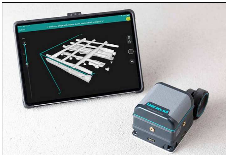
Obrázek 6 – RADAR PROCEQ GP 8800 s připojeným iPadem
