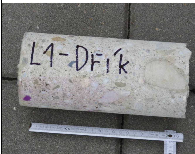
výnos z vrtu s fenolftaleinovým testem
