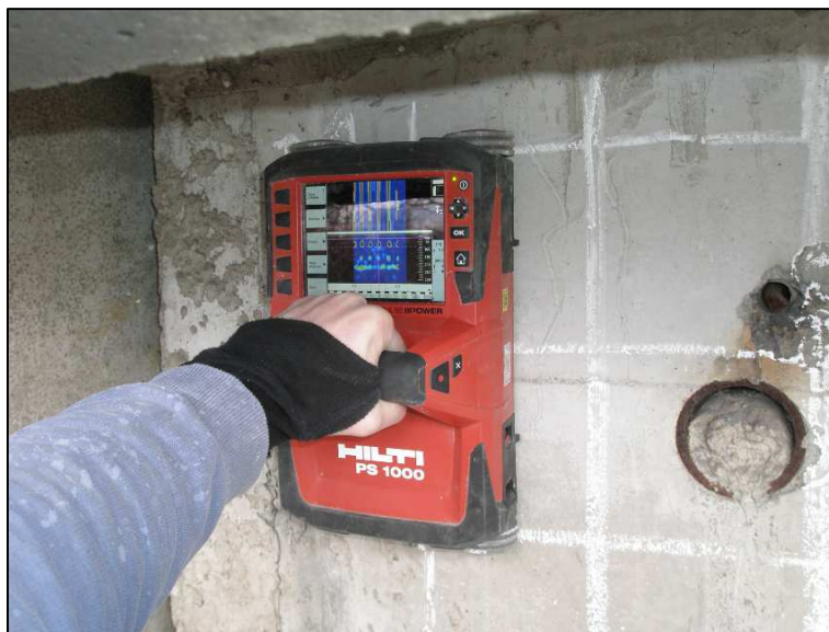
Obrázek 7 – RADAR HILTI PS1000 01X Concrete Pulse Radar.
