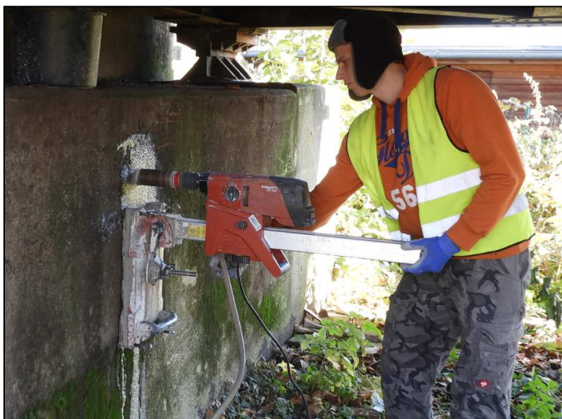
Obrázek 5 – odběr vzorku betonu
