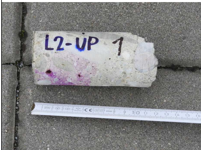
výnos z vrtu s fenolftaleinovým testem
